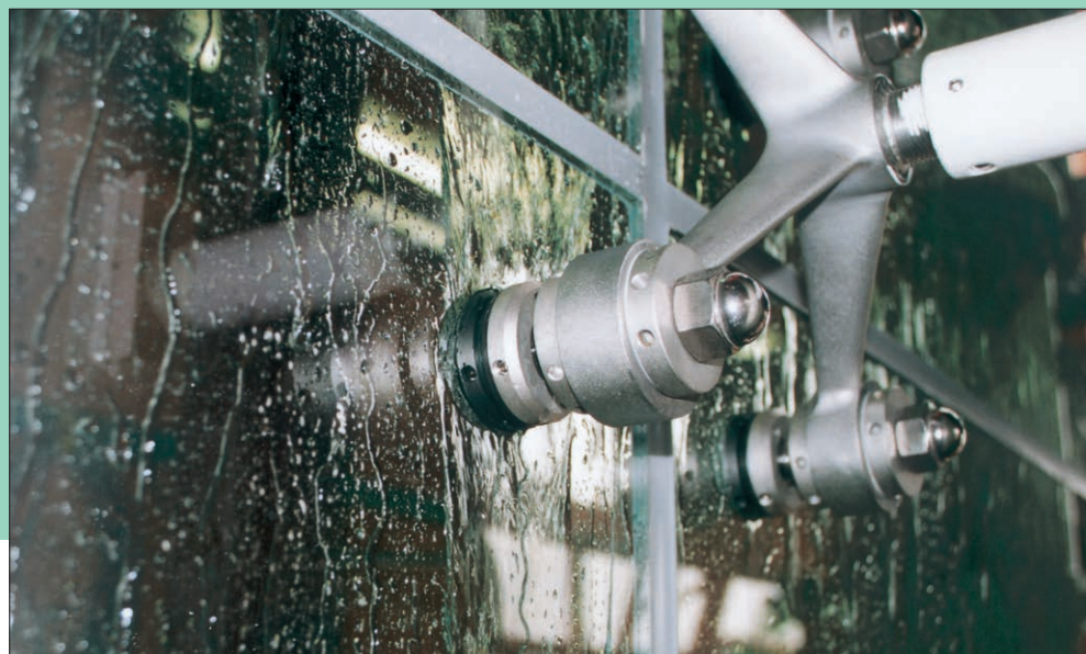
ガラス実大試験 (水密性能試験)
