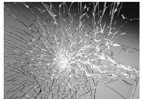
合わせガラスの割れパターン (フロートとフロートの組み合わせ)
