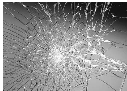
合わせガラスの割れパターン (フロートとフロートの組み合わせ)
