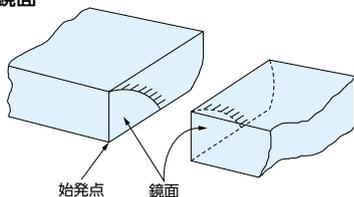
●熱割れは必ず板ガラスのエッジ部より発生し、図2のように割れの始発点付近の割れ目の線は上・下のエッジに直角です。割れの始発点には図3のように鏡面が存在します。発生する熱応力が大きい場合は破断面の枝分かれの数が多くなります。熱割れは、徐々に進行し数ヶ月以内で始発点より他の辺まで達することが多いようです。
