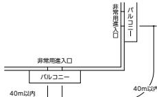
構造:屋外から開放できるもの、または破壊して室内に進入できるものとする。
